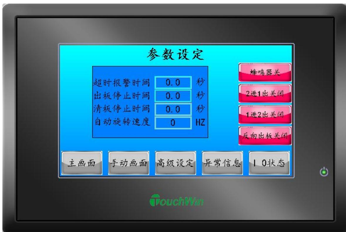
**蜂鸣器开/关:**通过此开关可以打开或关闭蜂鸣器声音
