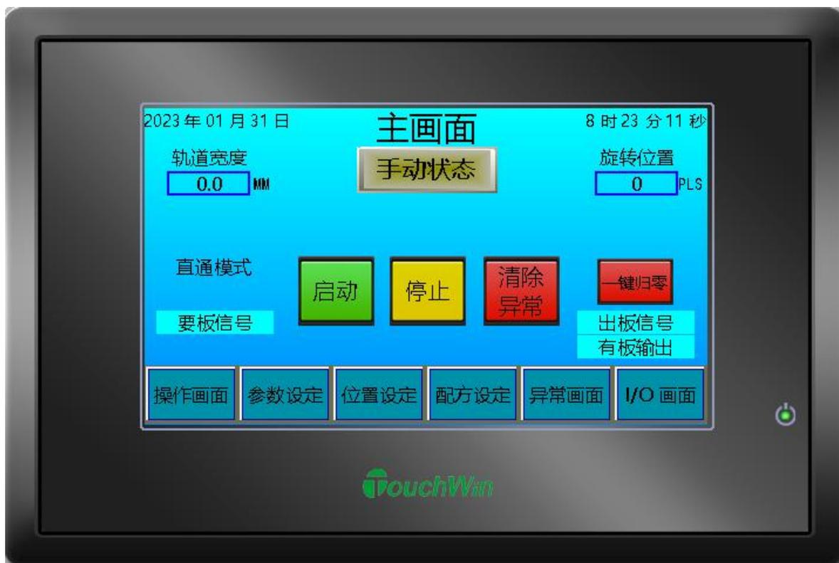
**轨道宽度** **0.0** MM 显示当前轨道宽度 **旋转位置** **0** PLS 显示旋转平台位置
